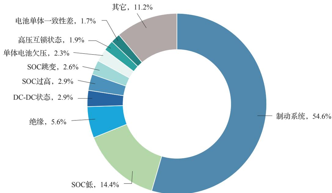
图 41 2020年新能源乘用车故障数量占比构成
