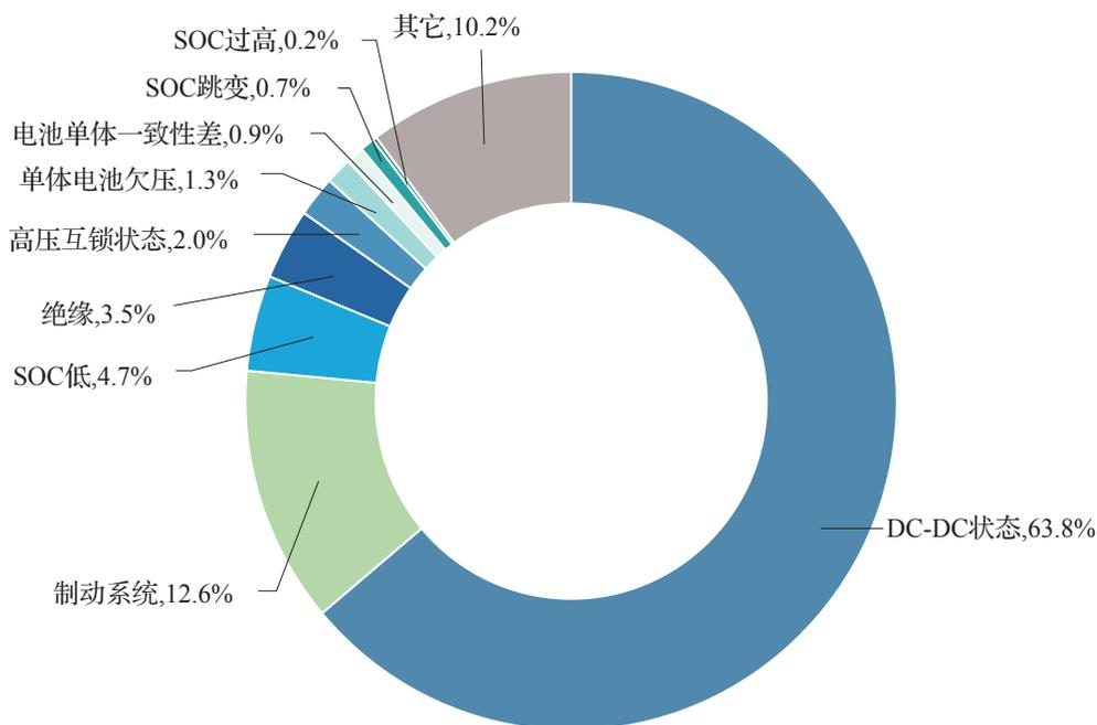
图 42 2020年新能源商用车故障数量占比构成
